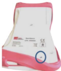
Figura 3: Botão de reinicialização do dispositivo portátil
